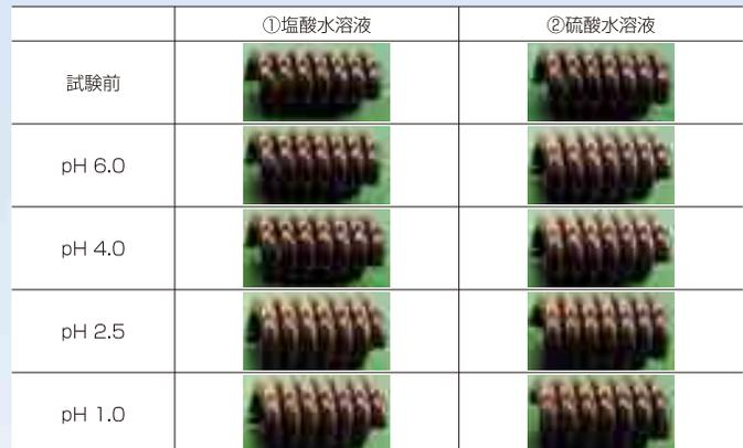
写真II-13 塩酸水溶液・硫酸水溶液浸漬後の外観
