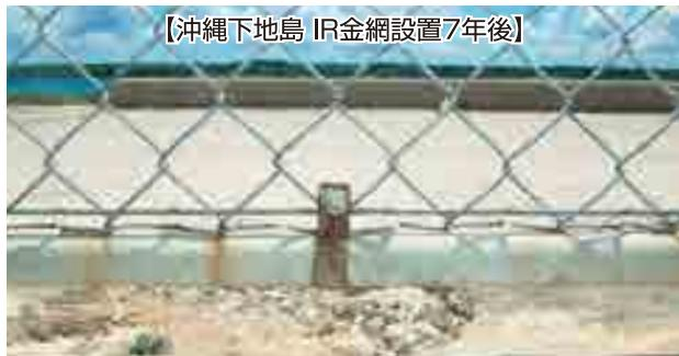
心線材が露出している端部は若干のサビが確認できるが、樹脂と心線材を完全接着しているため、端部からサビの進行は見受けられない。
