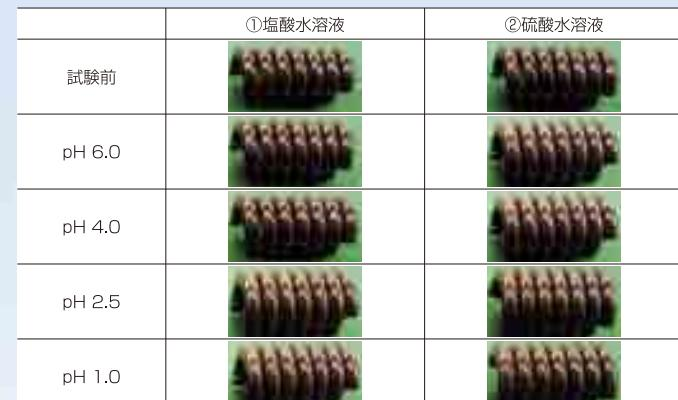
写真II-13 塩酸水溶液・硫酸水溶液浸漬後の外観
