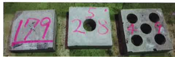
写真-2 被覆ブロック模型詳細(開口率0%(左)、8%(中央)、24%(右))
