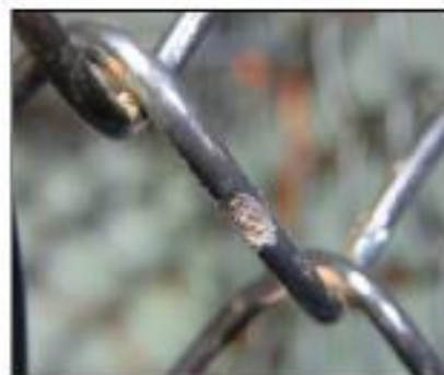
写真-1 塩水噴霧試験状況
