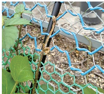
静電気を利用した除草装置、下部線はトワロン製の被覆鉄線
