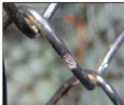
写真-1 塩水噴霧試験状況
