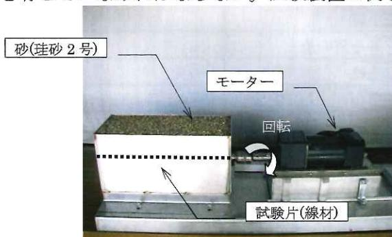
解写真-1 線材磨耗試験装置の例
