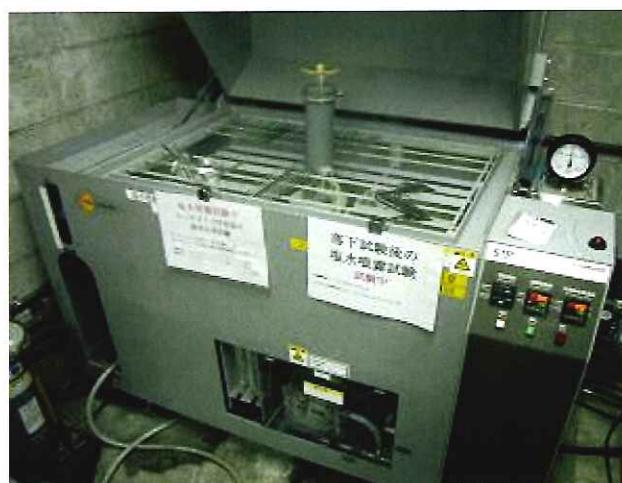
写真 II-5 腐食促進試験装置
