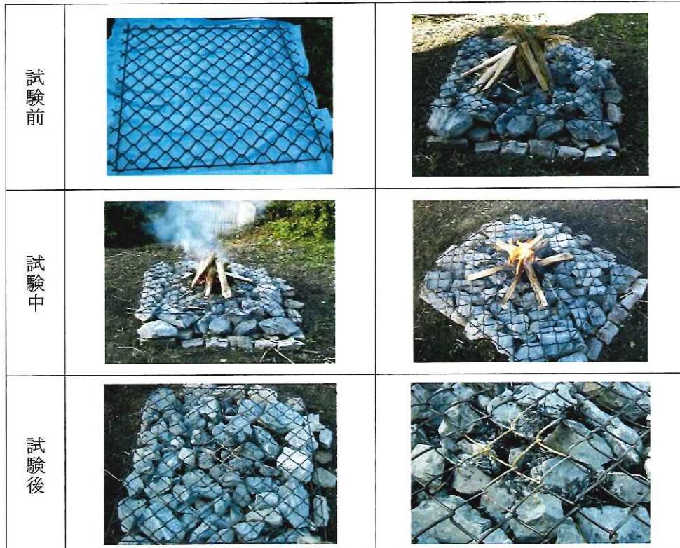
写真 II-20 たき火試験結果
