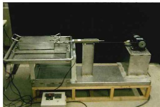
写真 II-21 線的摩擦試験状況
