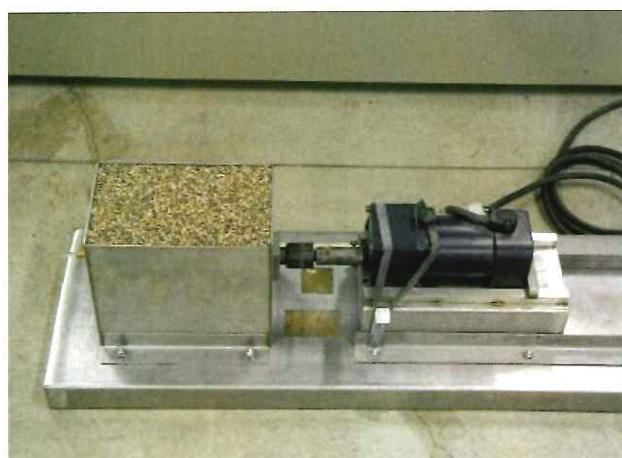
写真 II-4 線材磨耗試験装置
